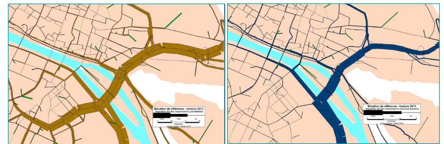
Illustration 50: Répartition des flux empruntant le pont Mathilde et le boulevard industriel, en situation de référence (Source : étude du CEREMA, 2015)
