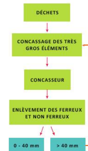
Illustration 13 : Cycle des matériaux de déconstruction
