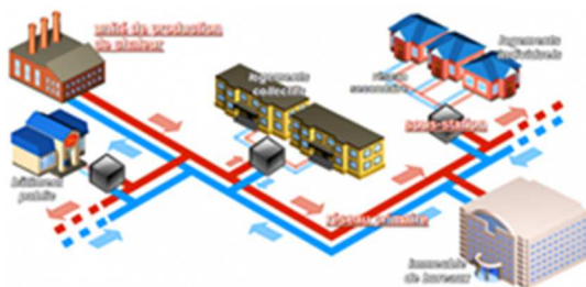
Schéma réseau de chaleur (source Cerema)
