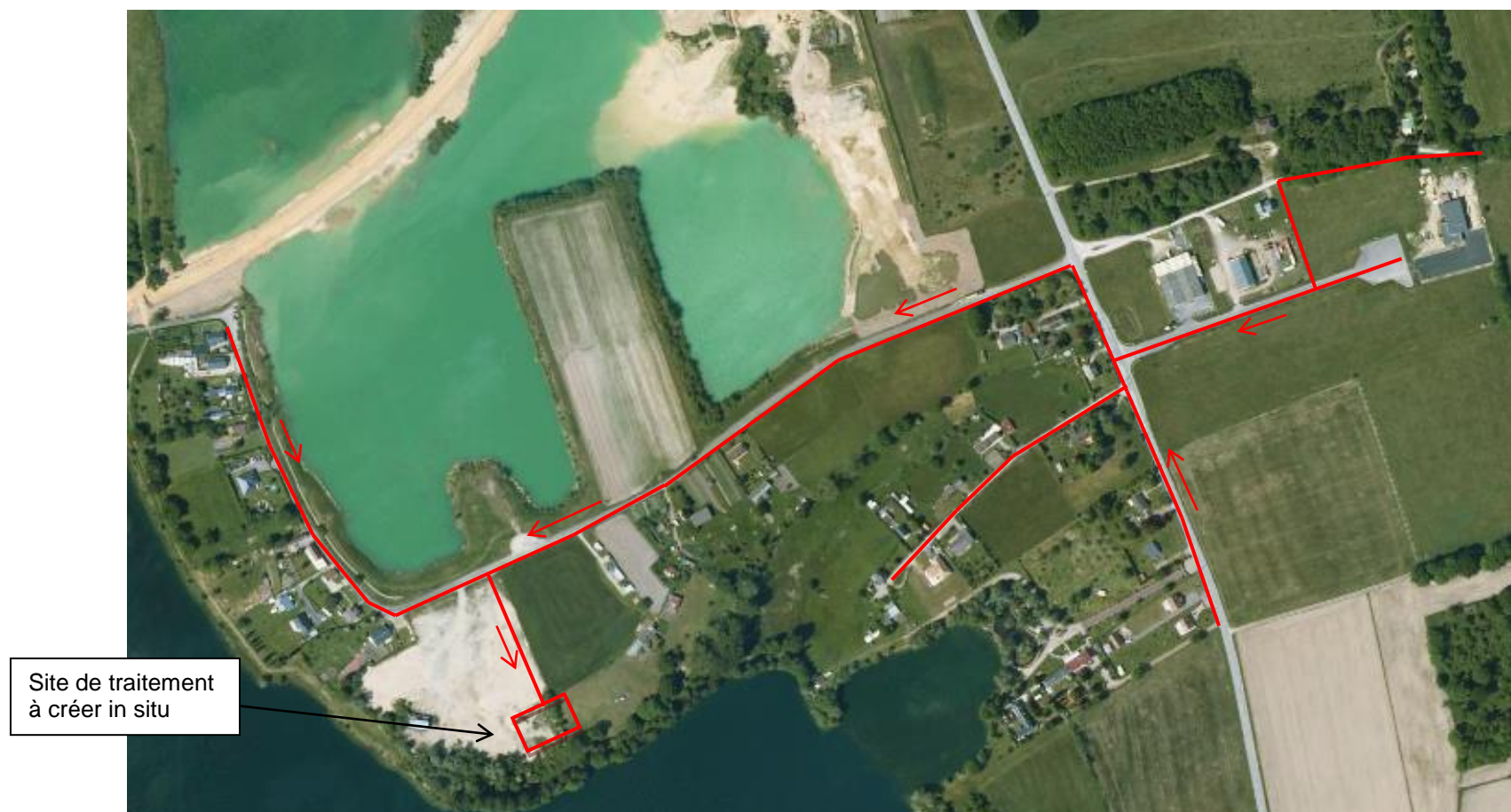
Figure 5 : Représentation graphique de la solution d'assainissement collectif étudiée pour le secteur Les Nouettes / Chêne Bénard / La Grève
