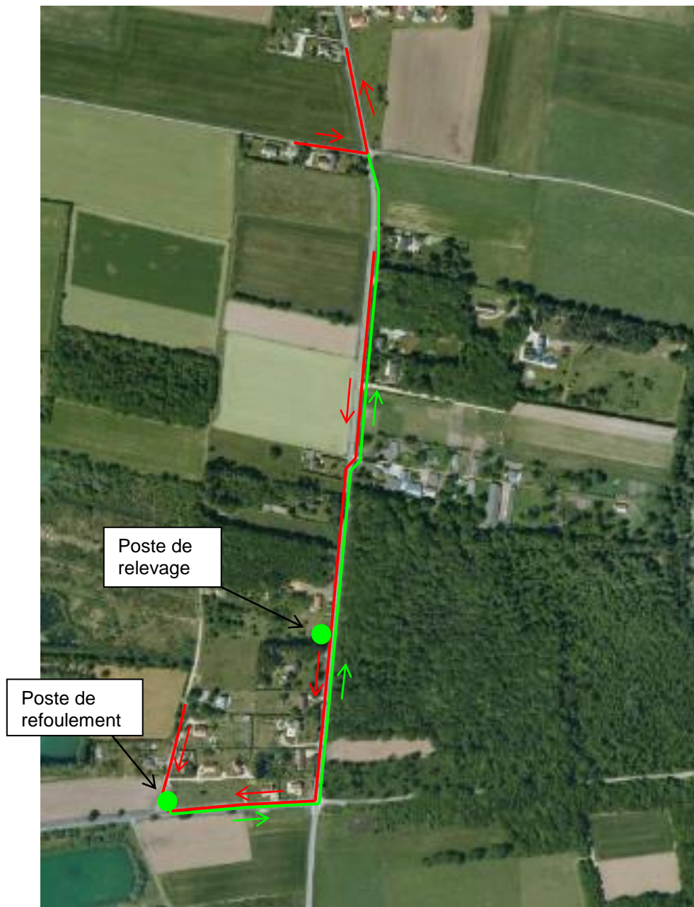
Figure 4 : Représentation graphique de la solution d'assainissement collectif étudiée pour le hameau Le Claquevel
