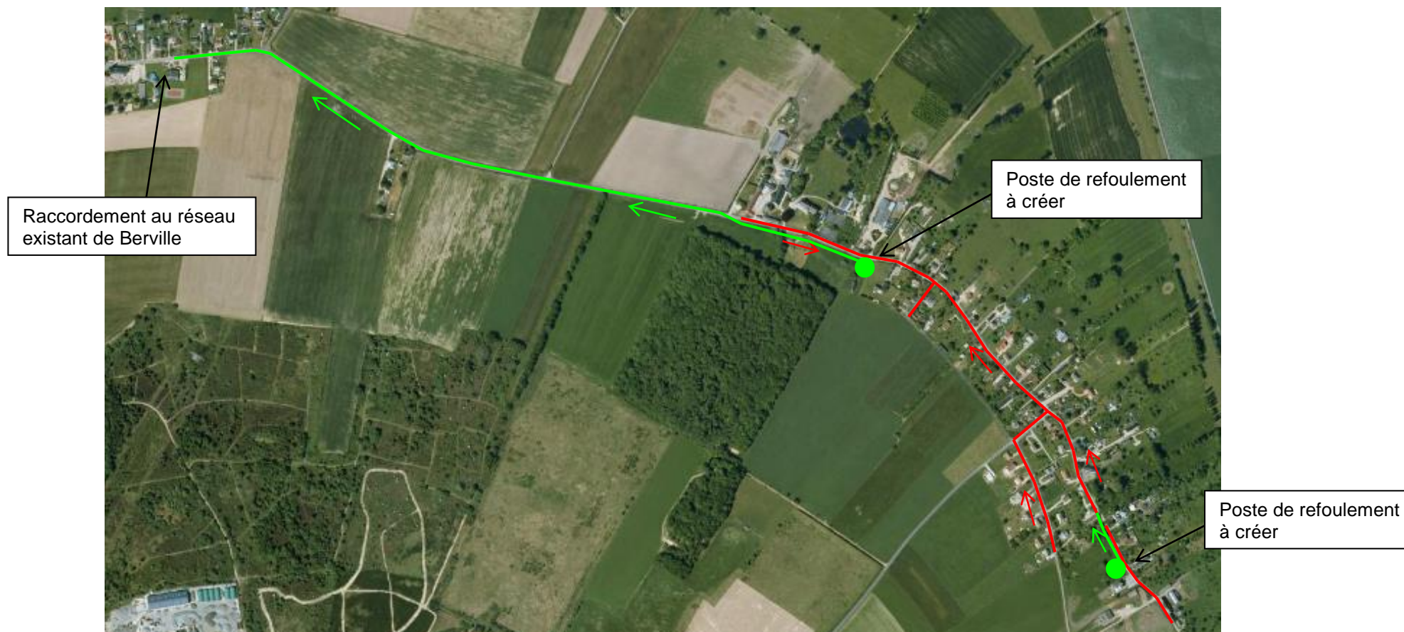
Figure 6 : Représentation graphique de la solution d'assainissement collectif n°2 étudiée pour le hameau Ambourville
