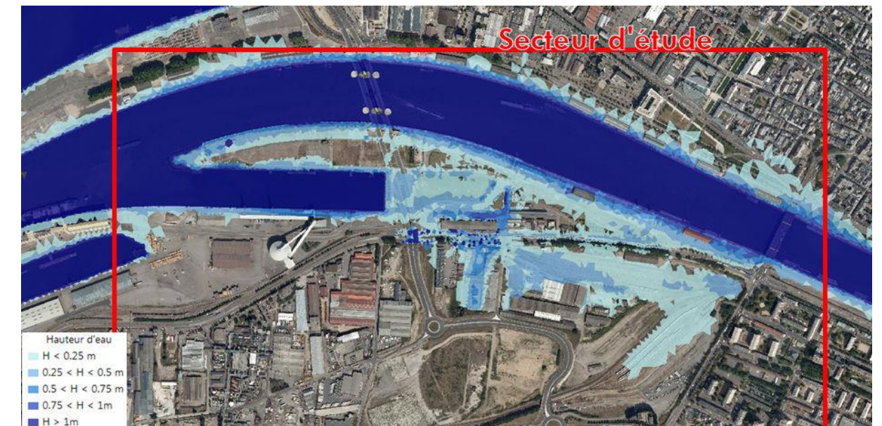
Schéma 126 : Résultats de la simulation en « état actuel » exprimés en hauteur d'eau (DHI - 2015)
