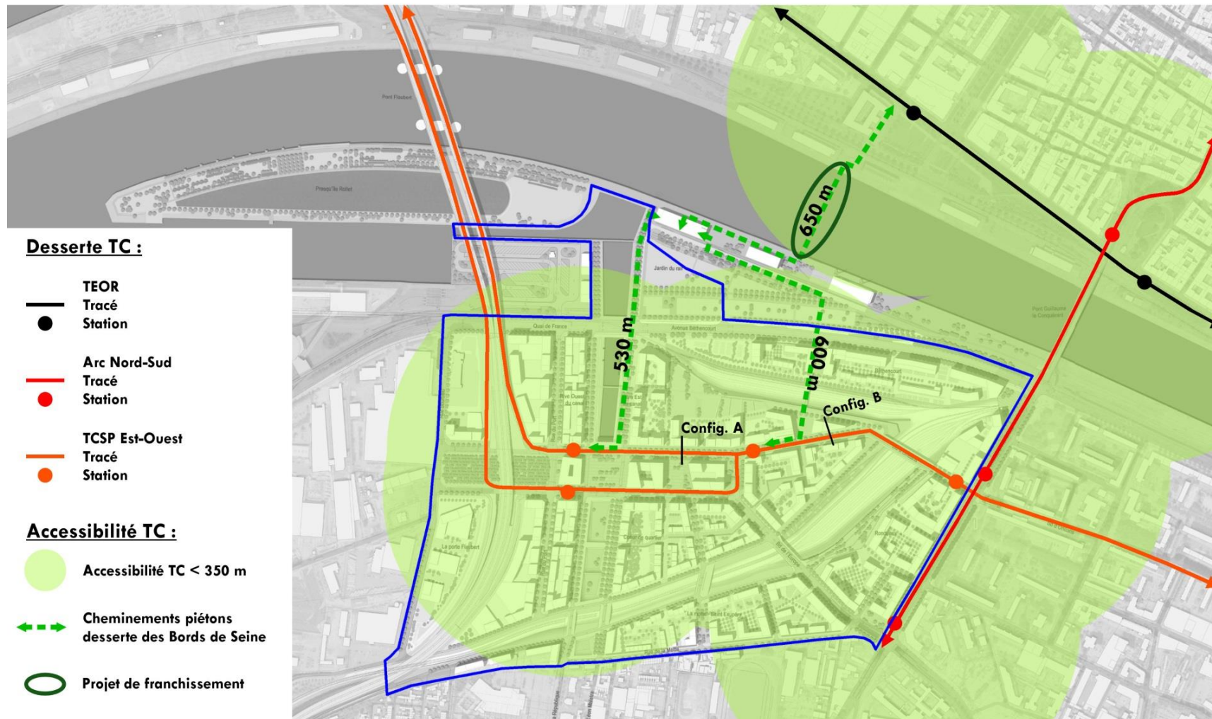
Schéma 31 : Configurations types du TCSP Est-Ouest au sein de la ZAC (OSTY-ATTICA-EGIS-BURGEAP - 2014)
