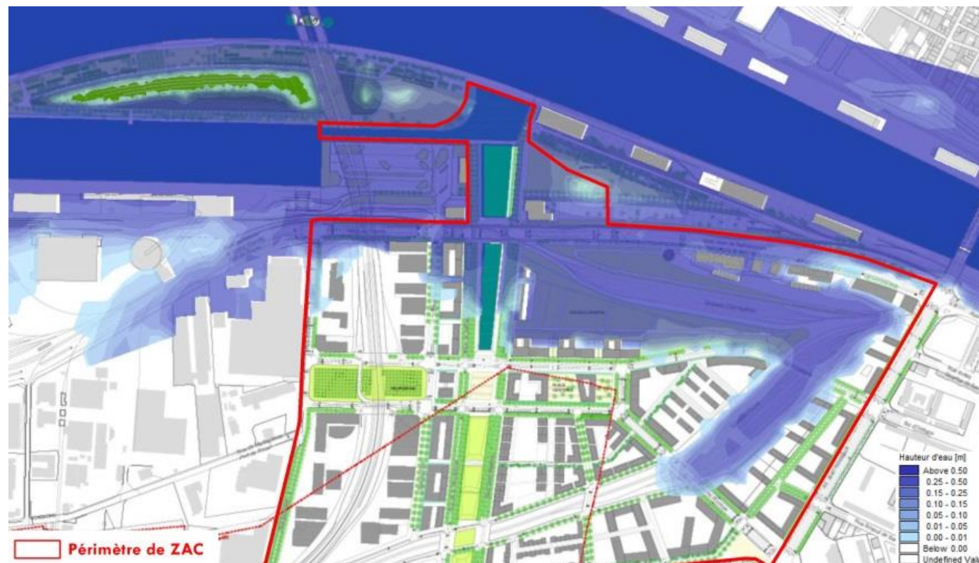
Schéma 227 : Résultats de la simulation en « situation aménagée incluant une rehausse du niveau de la Seine de 32 cm à Rouen » exprimés en hauteur d'eau (DHI - 2012)
