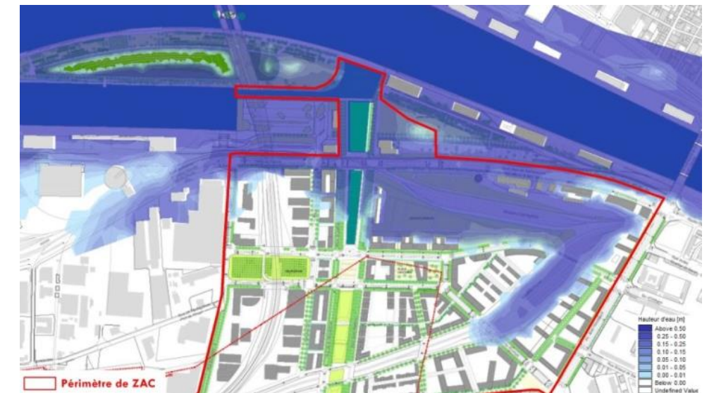
Résultats de la simulation en « situation aménagée incluant une rehausse du niveau de la Seine de 32 cm à Rouen » exprimés en hauteur d'eau (DHI - 2012)
