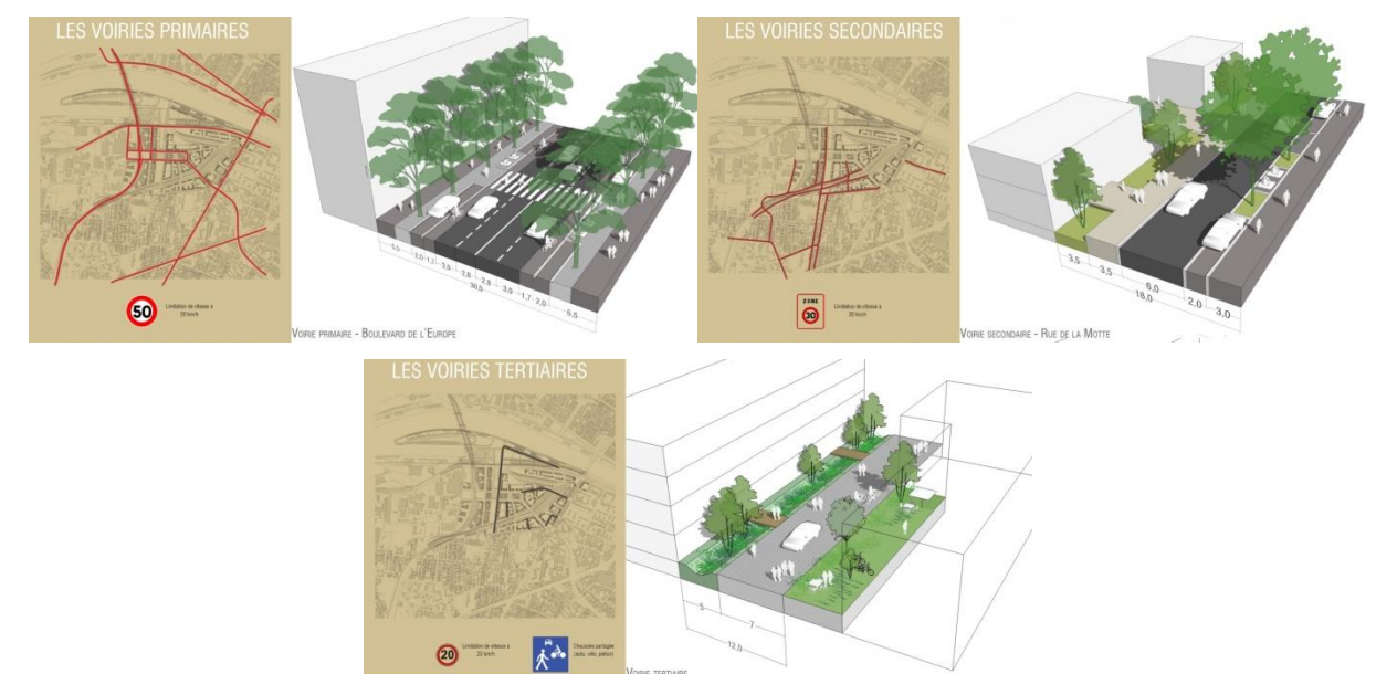
Schéma 236 : Identification et coupe de principe des différents niveaux de voiries de la ZAC éco-quartier Flaubert (OSTY-ATTICA-EGIS-BURGEAP - 2014)
