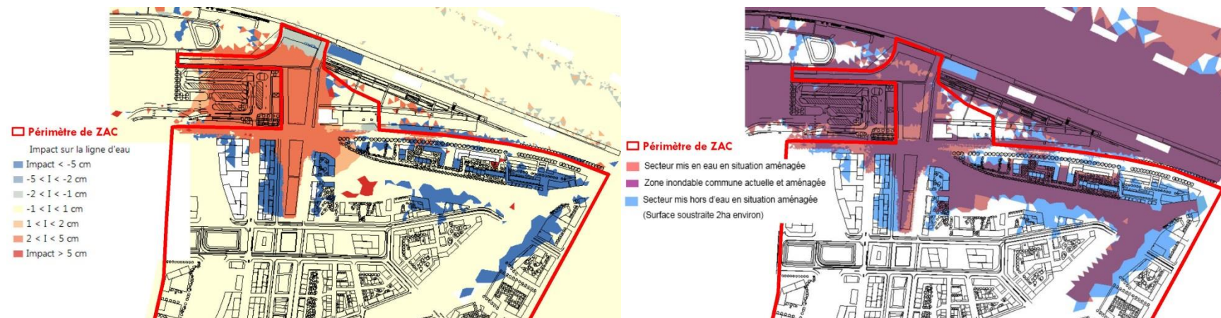
Schéma 226 : Impact des travaux de terrassement sur les hauteurs d'eau et sur les emprises de la zone inondable par rapport à la situation actuelle de 2015 (DHI - 2015)
