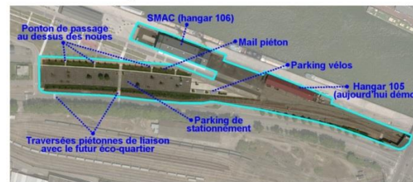
Détail des aménagements de la SMAC et de ses abords
