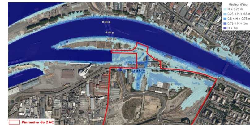
Schéma 50 : Modélisation du champ d'expansion de crue par débordement de la Seine : Résultats de la situation future (DHI - 2015)
