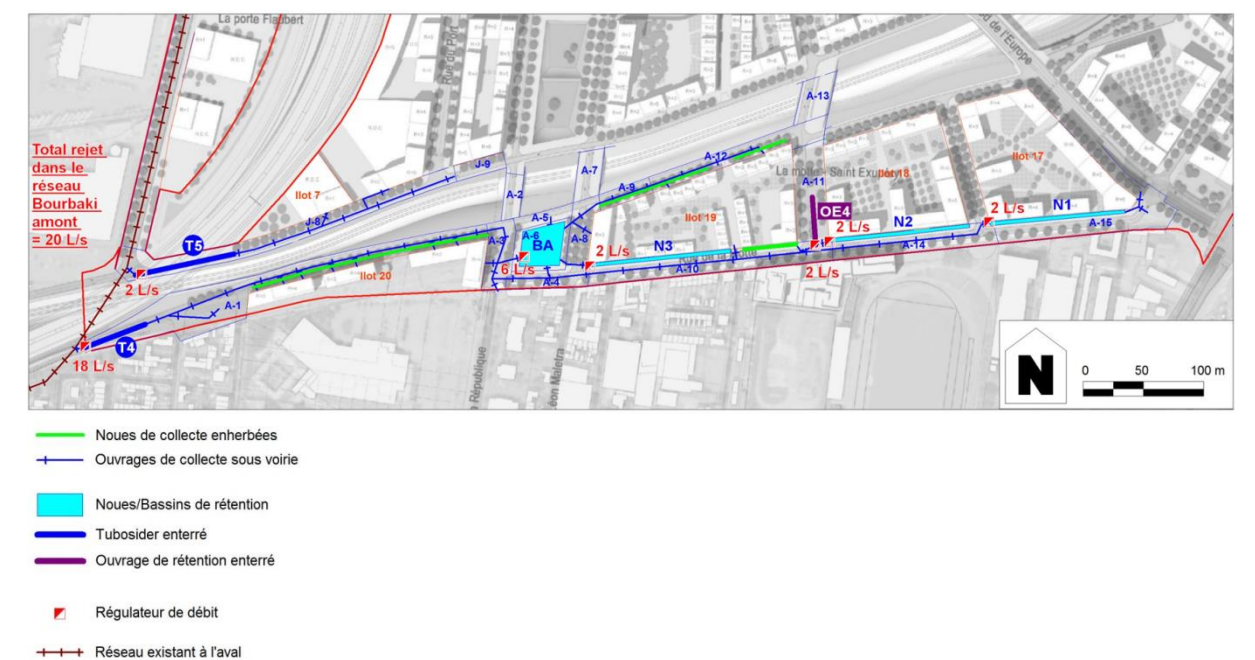
Schéma 59 : Ouvrages de gestion des eaux pluviales du Bourbaki amont (INGETEC d'après visuels de l'équipe de maîtrise d'œuvre 64 )
