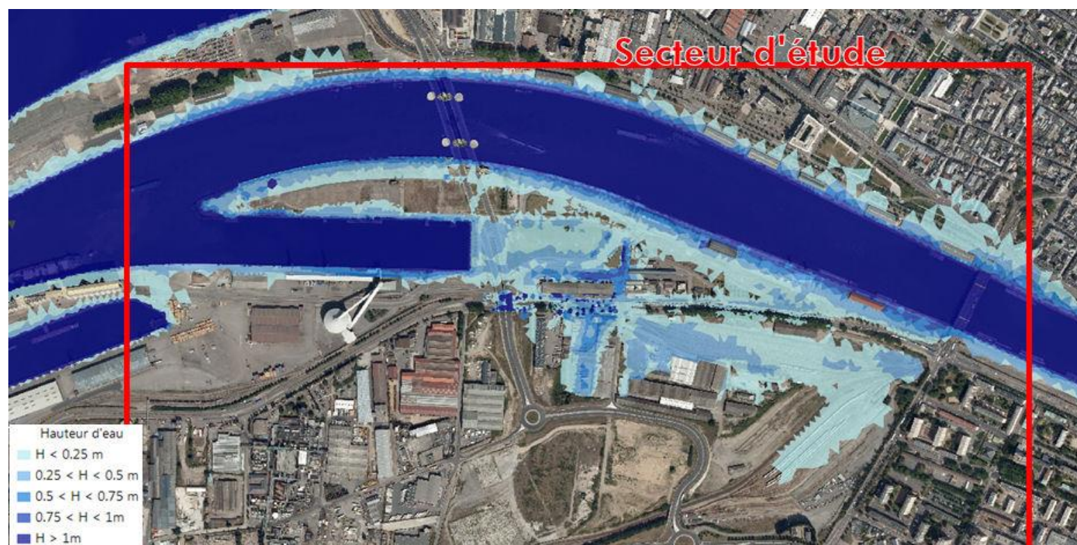
Schéma 127 : Résultats de la simulation en « état actuel » exprimés en hauteur d'eau (INGETEC - 2015)
