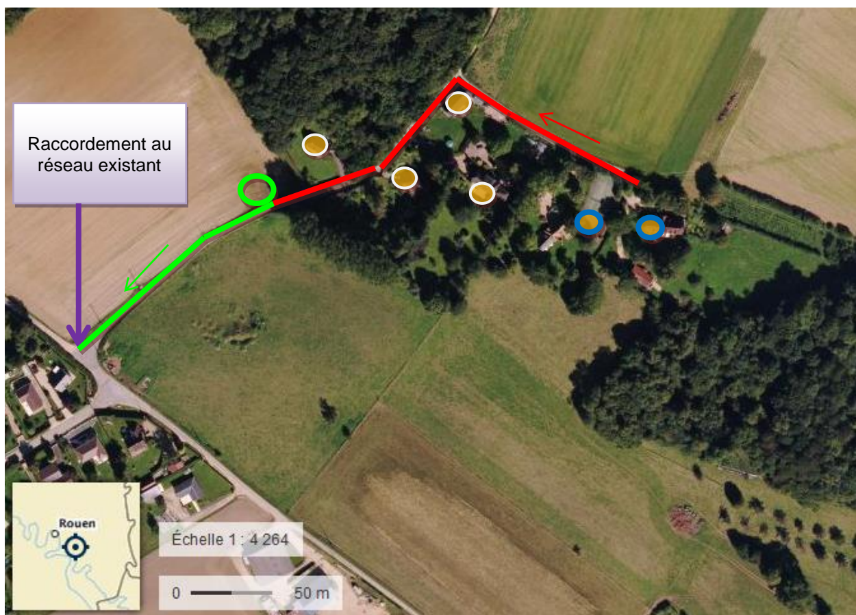
Figure 3 : Représentation graphique de la solution d'assainissement collectif étudiée pour le secteur de la Cote de l'Ane (6 unités)
