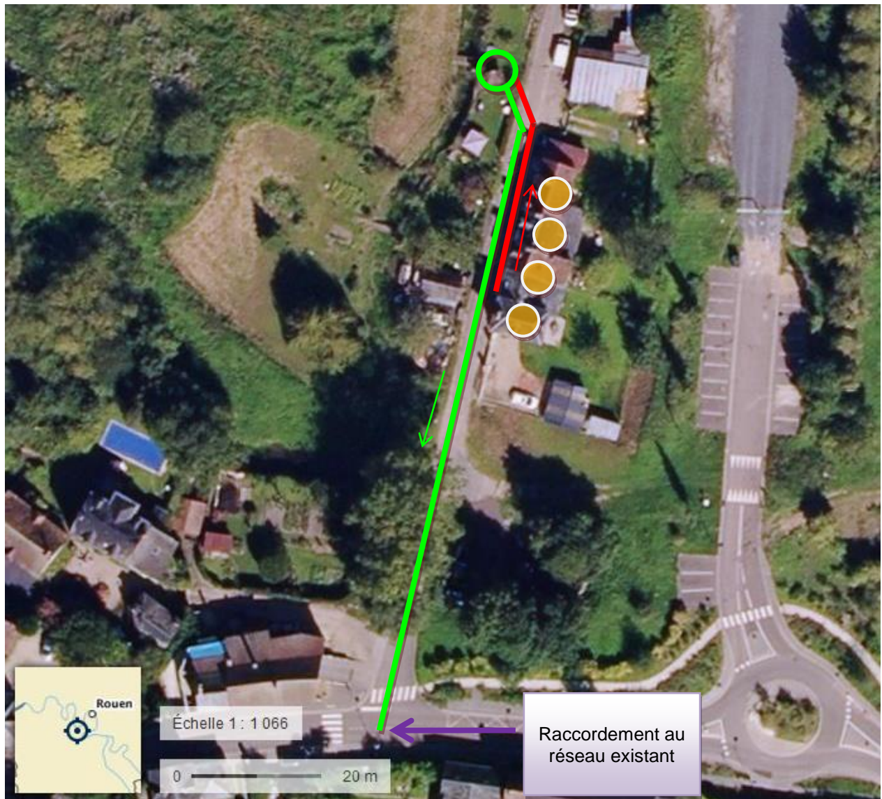
Figure 4 : Représentation graphique de la solution d'assainissement collectif étudiée pour le chemin de la Laiterie
