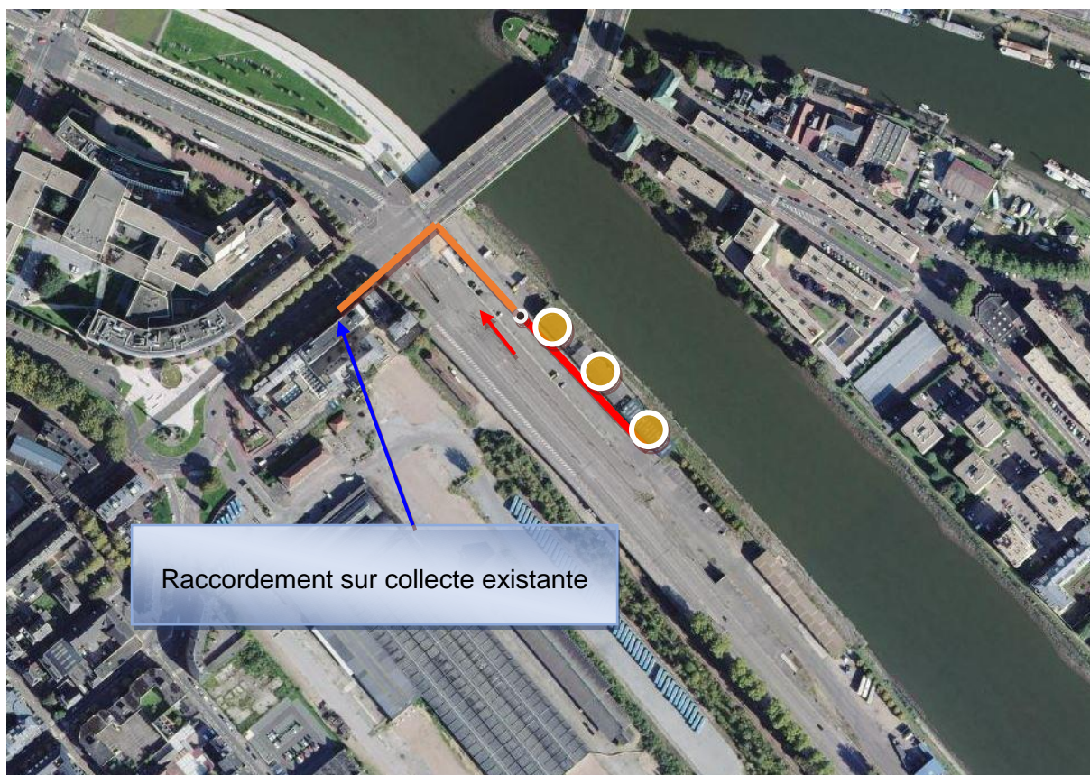
Figure 10 : Représentation graphique de la solution d'assainissement collectif étudiée pour le secteur de la rue Quai Jacques Aquetil (1 unité)
