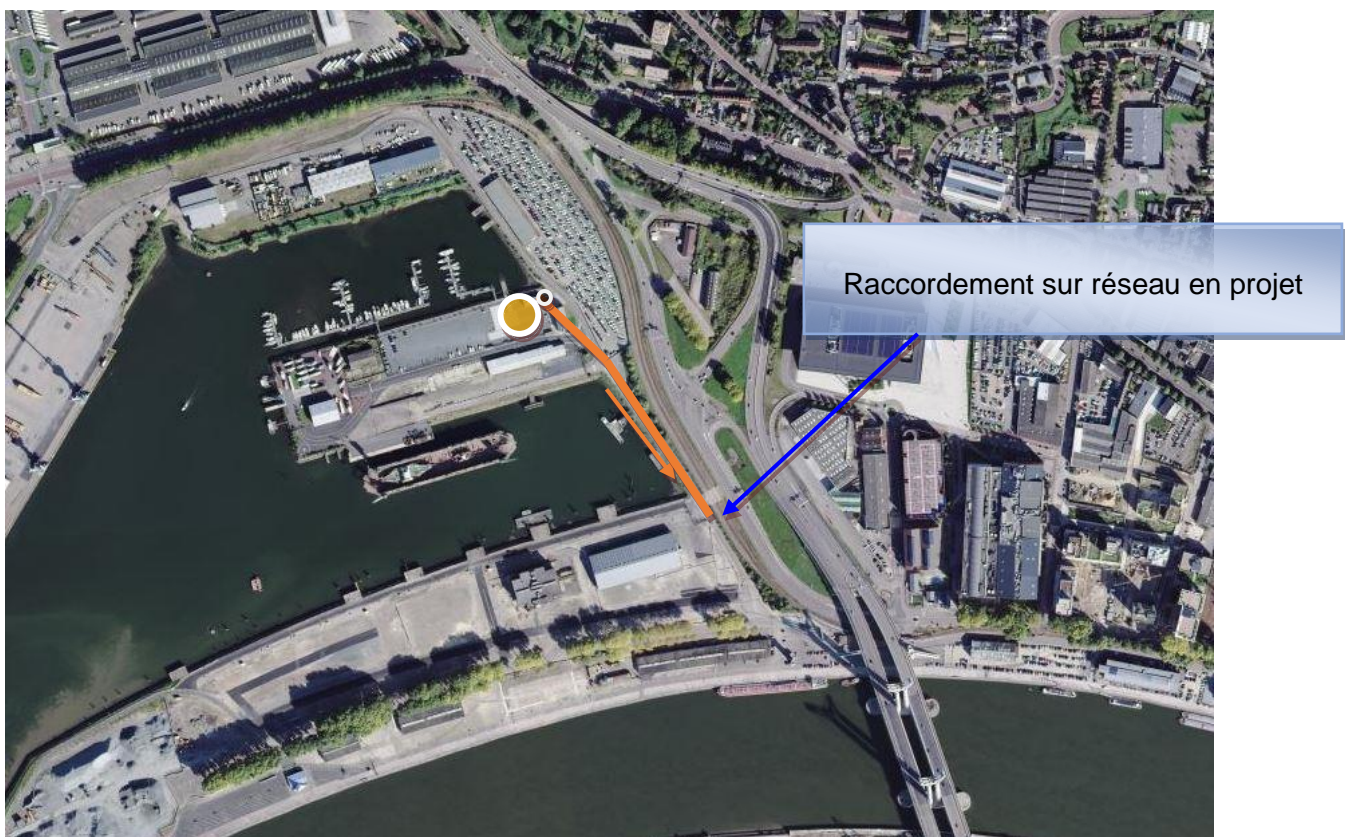
Figure 9 : Représentation graphique de la solution d'assainissement collectif étudiée pour le secteur de la rue Nansen(1 unité)
