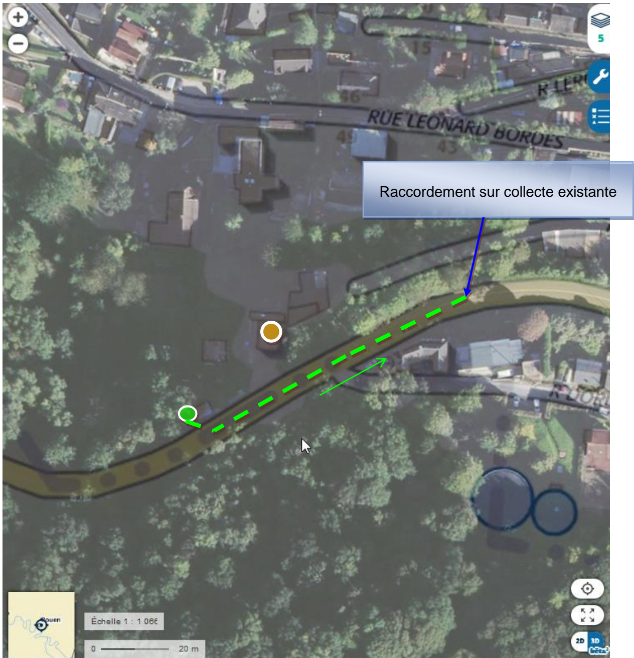
Figure 5 : Représentation graphique de la solution d'assainissement collectif étudiée pour le secteur de la rue Annie de Penne (1 unité)
