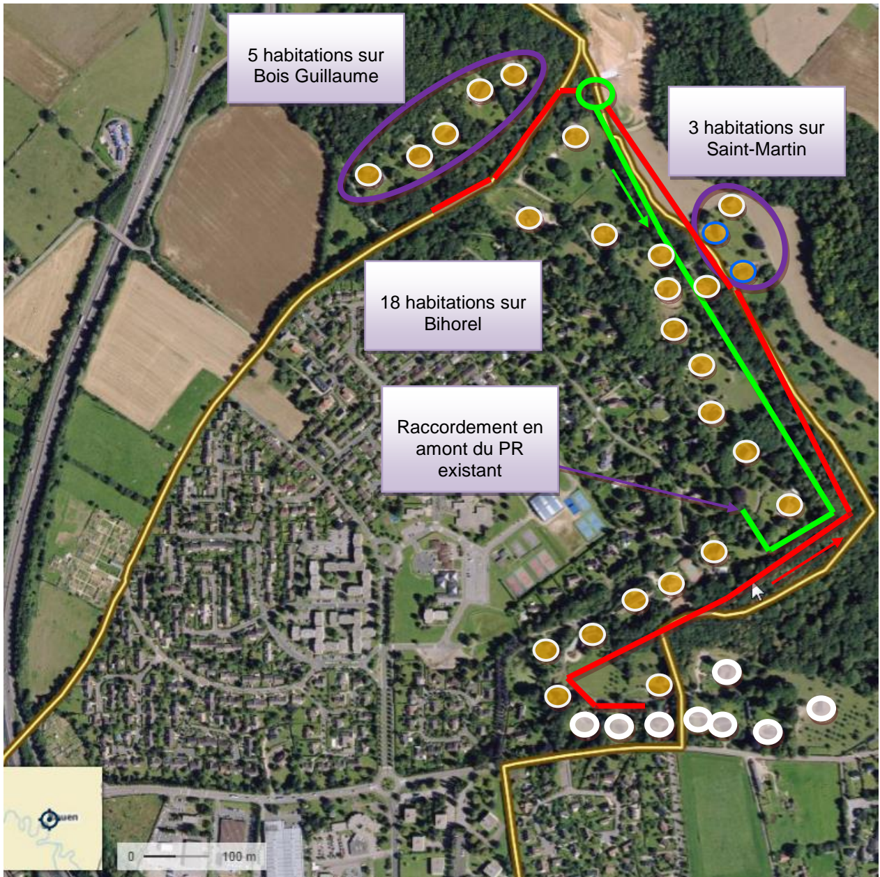
Figure 6 : Représentation graphique de la solution d'assainissement collectif étudiée pour le secteur du Domaine du Chapitre
