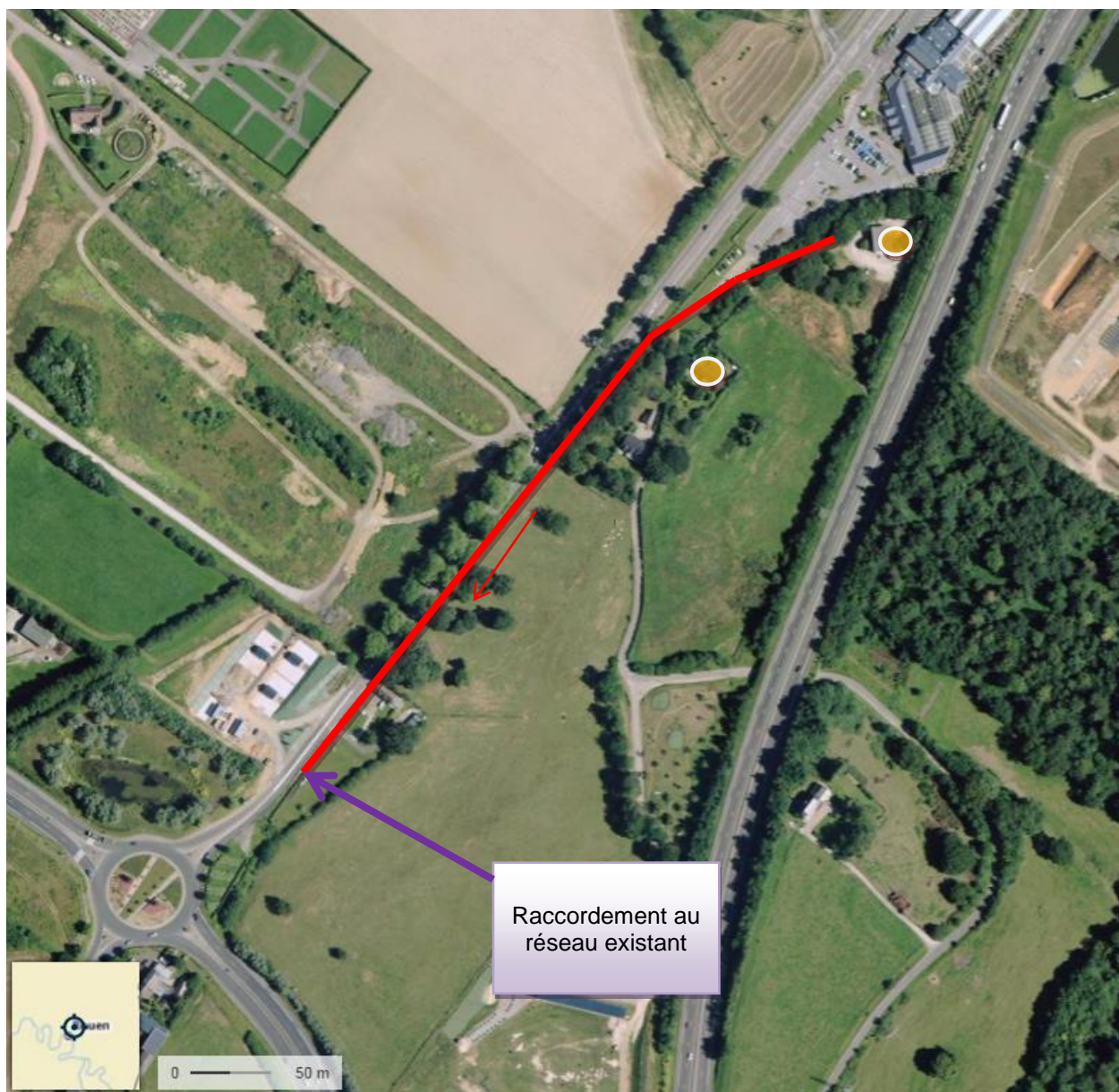
Figure 7 : Représentation graphique de la solution d'assainissement collectif étudiée pour le secteur de la Ronce
