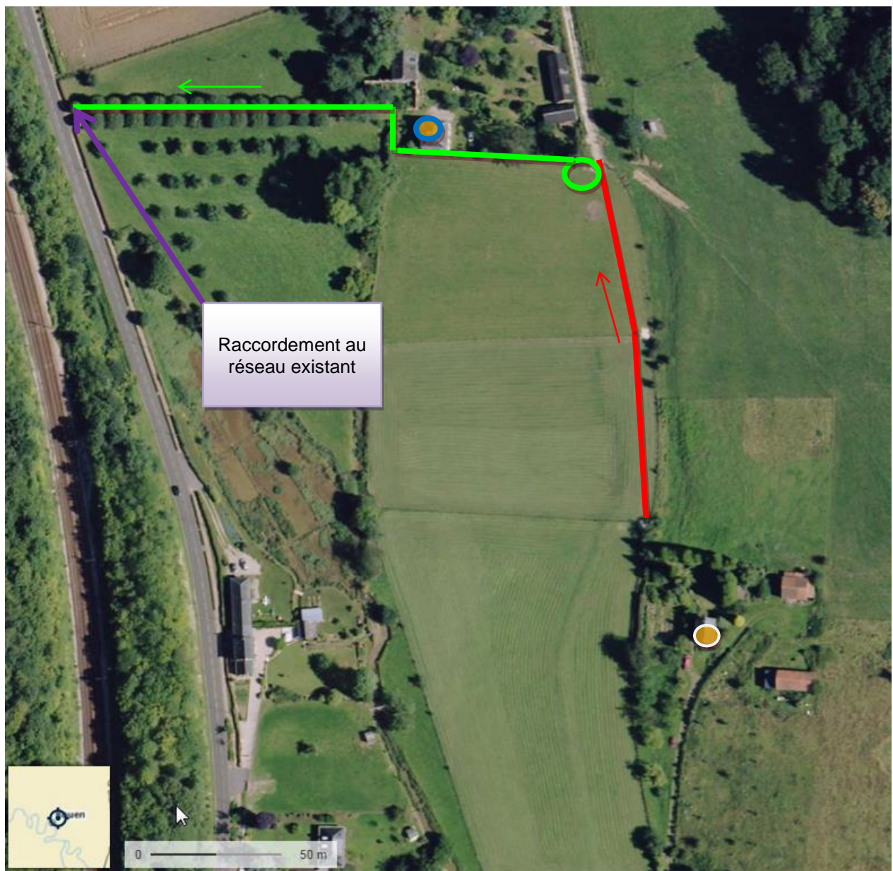
Figure 4 : Représentation graphique de la solution d'assainissement collectif étudiée pour le secteur du chemin du Vieux-Moulin
