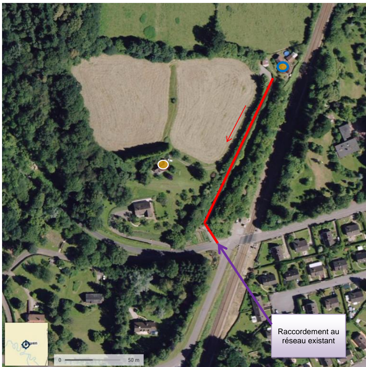
Figure 5 : Représentation graphique de la solution d'assainissement collectif étudiée pour le secteur de l'impasse du Coteau
