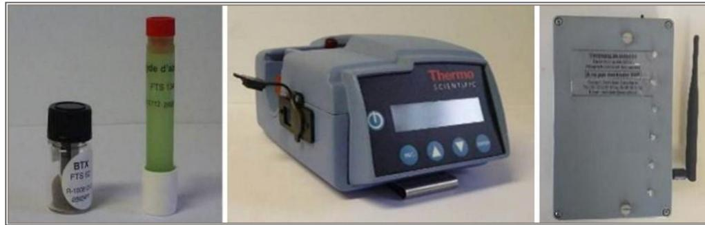
Photo 2 : Tubes passifs, néphélomètre et micro-capteur laser
