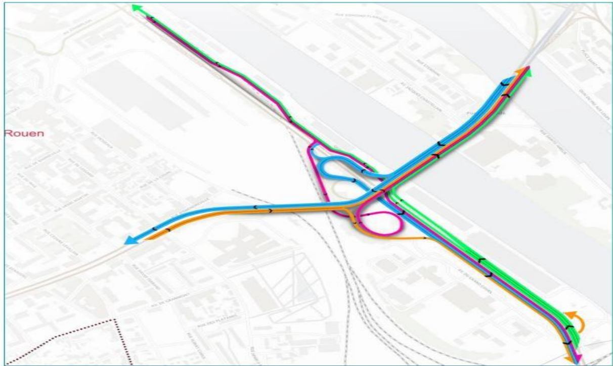
Illustration 3 : Schéma fonctionnel de la solution retenue pour le réaménagement de la tête sud du pont Mathilde, à terme
