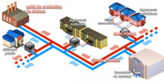
Schéma réseau de chaleur (source Cerema)
